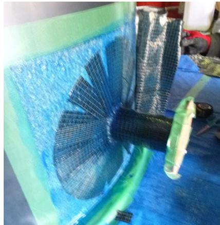
図3-20 ノズル周方向への貼付け
