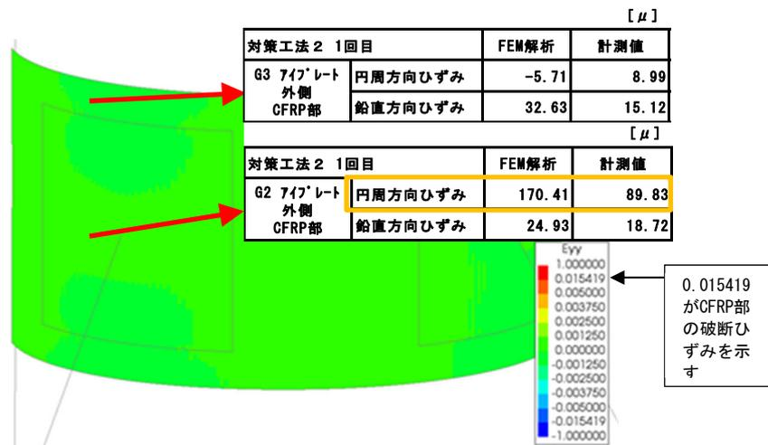
図3-88 CFRP表面の円周方向ひずみ
