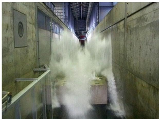
図3-20 大規模波動地盤総合水路（国立研究開発法人 港湾空港技術研究所 ホームページより引用）
