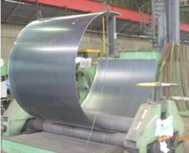
図3-25 タンク側板の板曲げ
