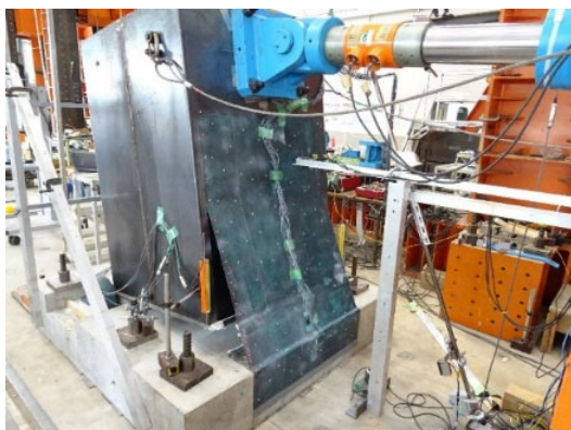
図1-4 実験模型の終局状態 (矩形)
