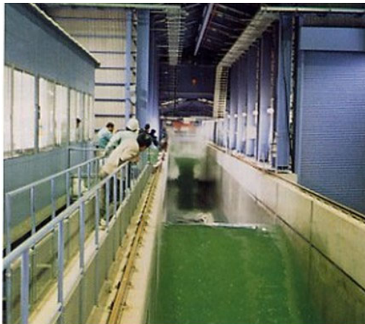
図3-20 大規模波動地盤総合水路（国立研究開発法人 港湾空港技術研究所 ホームページより引用）
