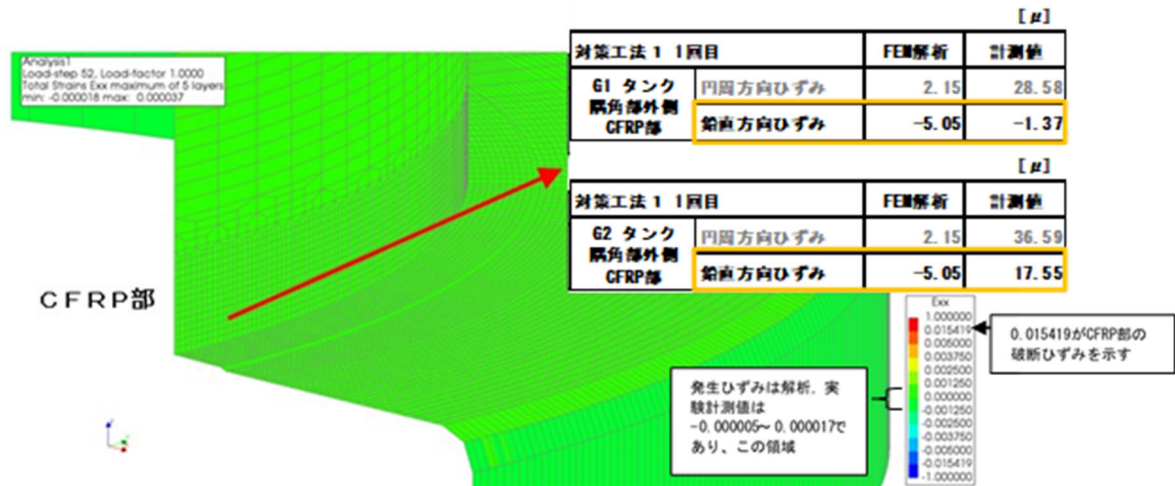
図 3-65 CFRPの側板鉛直・RCスラブ半径方向ひずみ (3.45kL・対策工法 1 実験 1 回目、液位20% 1.275m時)
