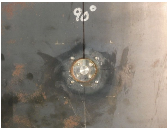
(3) タンクに取り付けた圧力計
