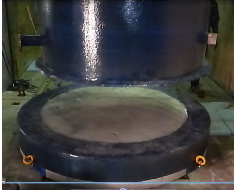
図 3-42 対策工法 1 の実験後の C F R P 内の状況（浸水のないことを確認）
