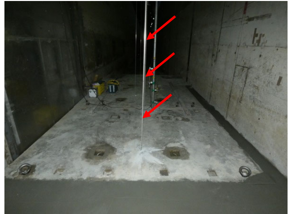
(2) 波高検定用の波高計と流速計（赤矢印）
