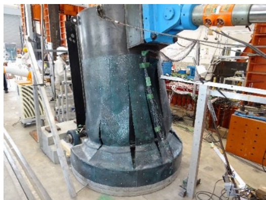
図1-5 実験模型の終局状態 (円形)
