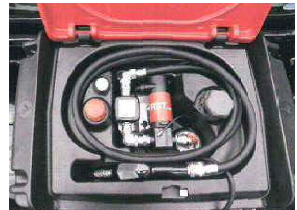
給油ノズル及び給油ホース収納状況
