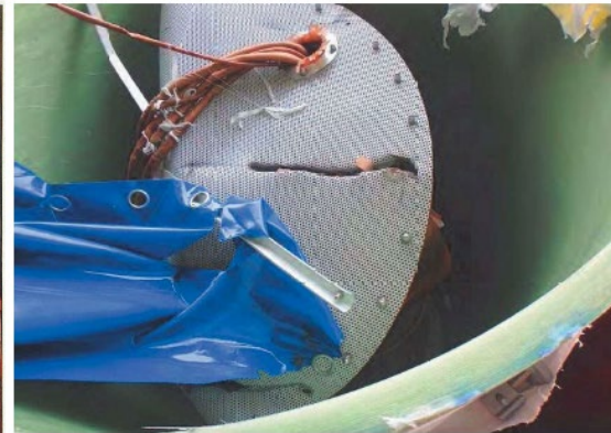
FRP製の変圧器から絶縁油の漏えい事故
