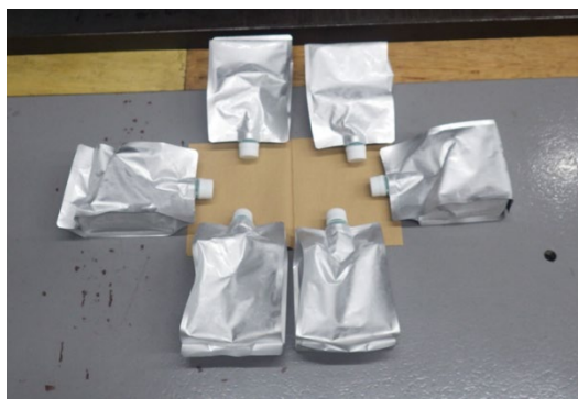
図3-7 内装容器の落下試験後の状況（底面落下）
