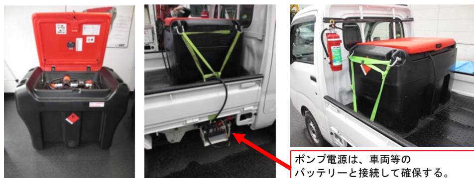
図 2－3 給油機器と一体となった構造の運搬容器の使用状況
