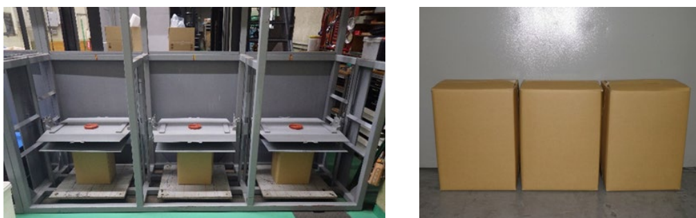
図3-9 積み重ね試験の実施状況（左から実施状況、積み重ね後の状況）
