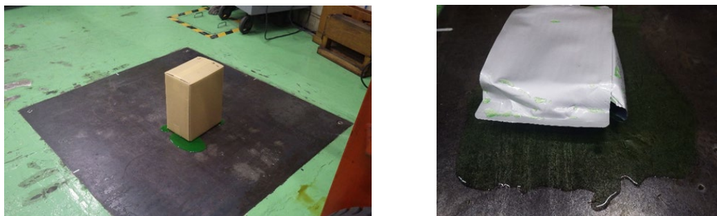
図 3-11 梱包方法の異なる組合せ容器の落下試験の実施状況 (つま面落下)
