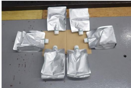
図1-7 内装容器の落下試験後の状況（底面落下）
