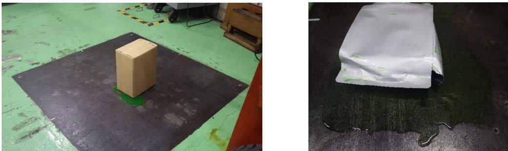
図 1-11 梱包方法の異なる組合せ容器の落下試験の実施状況 (つま面落下)
