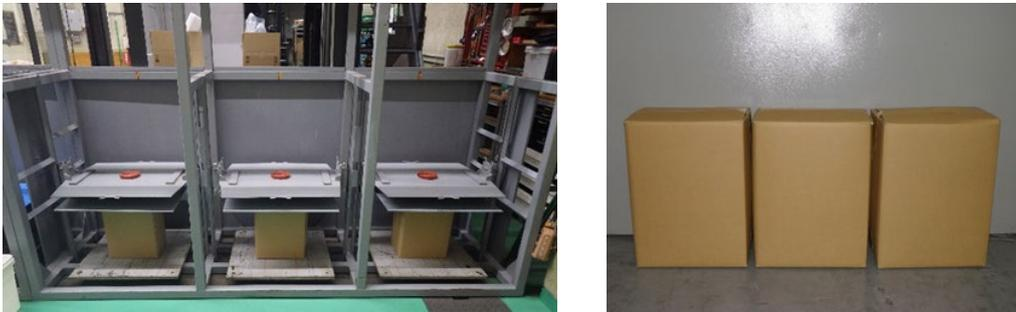
図1-9 積み重ね試験の実施状況（左から実施状況、積み重ね後の状況）
