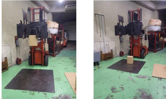
図1-6 落下試験（底面落下）の実施状況（左から落下前、落下後）
