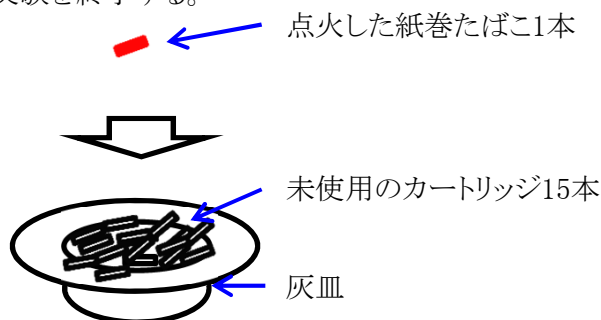
図6. 灰皿火災実験2 の説明図
